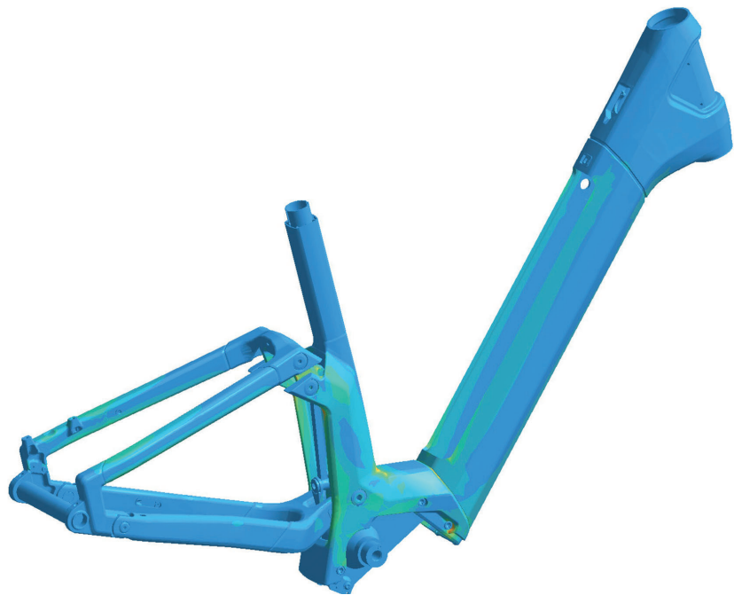
Bild 2: E-Bikes werden leistungsfähiger und die Rahmen schlanker, das bedingt eine gründliche Festigkeitsanalyse. Merida & Centurion Germany nutzt dazu Simsolid. (Foto: Centurion/Merida)
