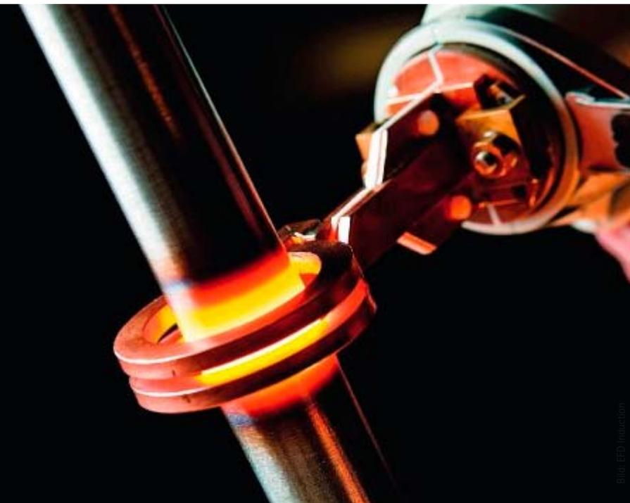
Per Induktion lassen sich ferromagnetische Werkstoffe lokal aufheizen und damit im definierten Bereich gezielt härten
