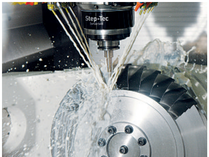
Step-Tec-Spindel in der 5-Achs-Simultanfräsmaschine Mikron Mill P 800 U. (Bild: Step-Tec)
