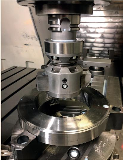
**Bild 1.** Das selbst konstruierte, aussteuerbare Ausbohrwerkzeug bewährt sich auch im Einsatz auf der Maschine. Foto: GFE
