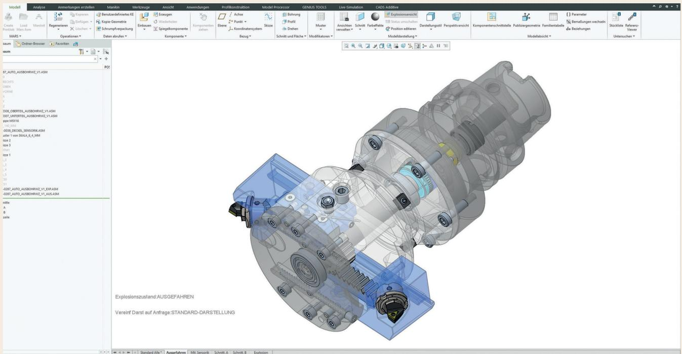
**Aussteuerbares Ausbohrwerkzeug** in der CAD-Darstellung: Bei der Entwicklung setzt die GFE Schmalkalden auf „PTC Creo“, um neue Zerspanungswerkzeuge, Komponenten und Baugruppen zu generieren. Foto: GFE / Inneo
