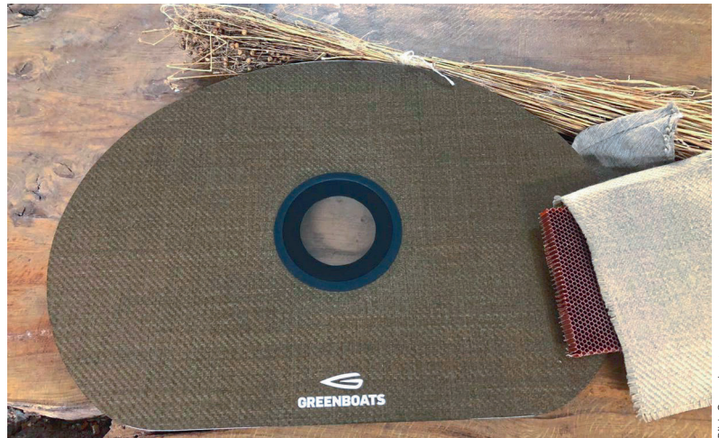
Greenboats entwickelt umweltfreundliche Faserwerkstoffe – im Bild: Flachfasern und Harz auf Leinölbasis.
