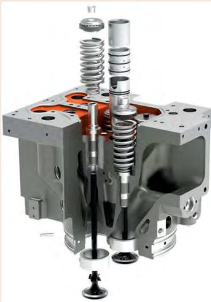
**Bild 4.** Für den Rennsport entstehen komplette Zylinderkopfkonzepte, die für hocheffizienten Gaswechsel und damit viel Leistung sorgen. Grafik: Steck/Inneo
