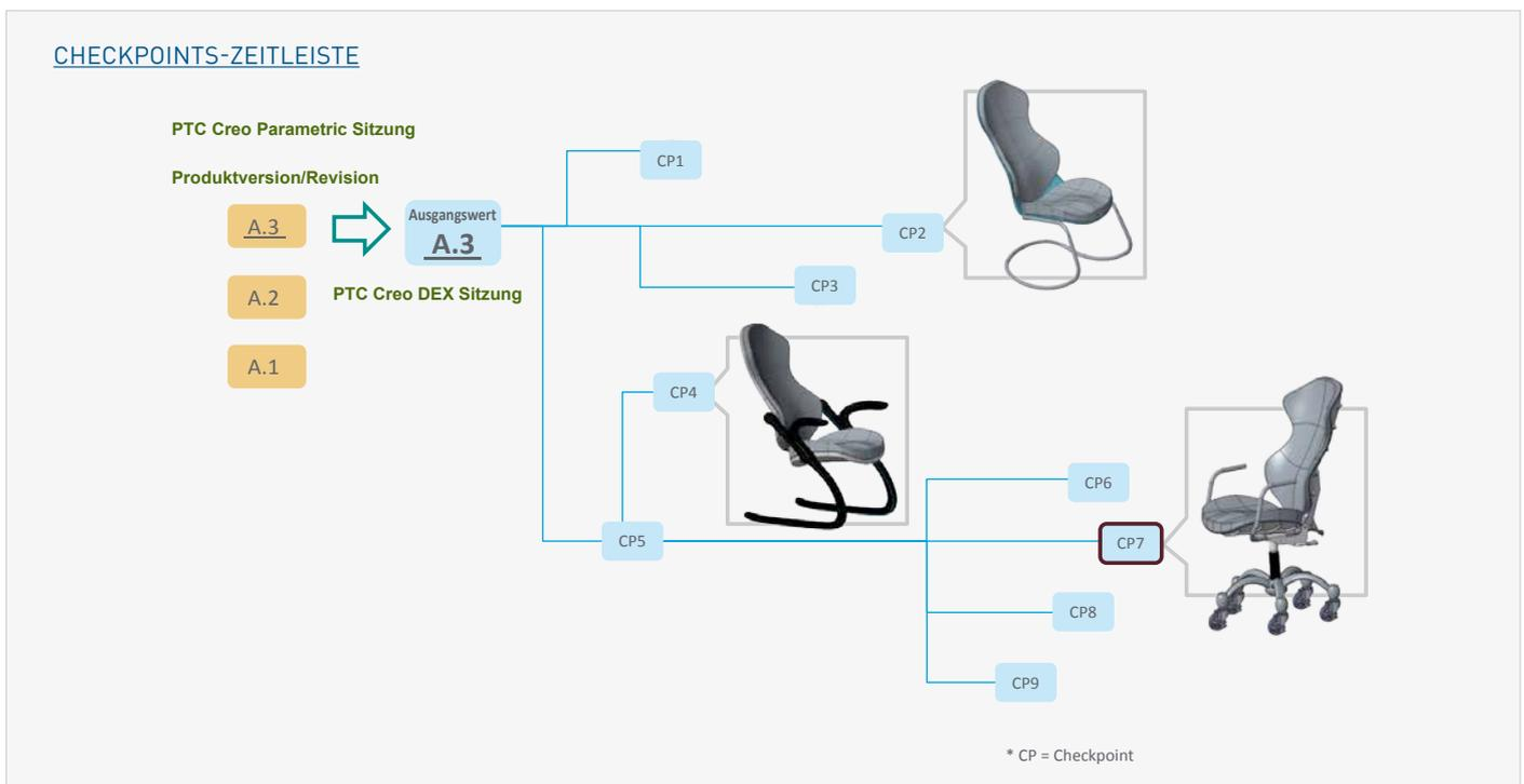
PTC Creo DEX ermöglicht das Hin- und Herwechseln zwischen gespeicherten Checkpoints zur Erkundung und Evaluierung unterschiedlicher Konstruktionsideen.
